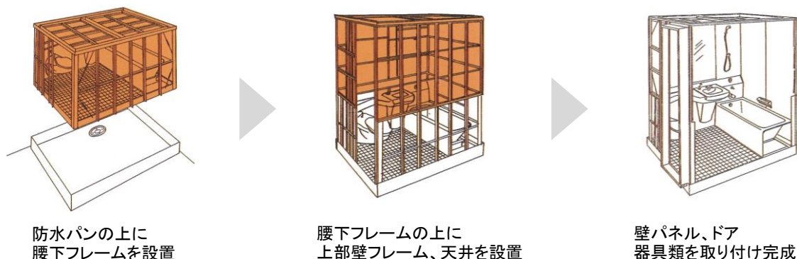
セミキュービック方式によるユニットバスルームの組み立て手順(一部抜粋)
