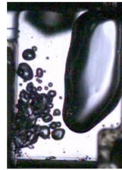
「バルーンジェット技術」は、水と空気の抵抗の差を利用し水玉吐水をつくっている
